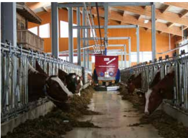
Das Nachschieben des Futters übernimmt der Roboter.
