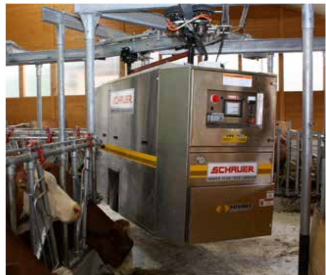
Kurvenradien und unterschiedliche Niveaus müssen beachtet werden.
