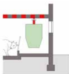
Schiene auf tragender Decke (Bestand).
