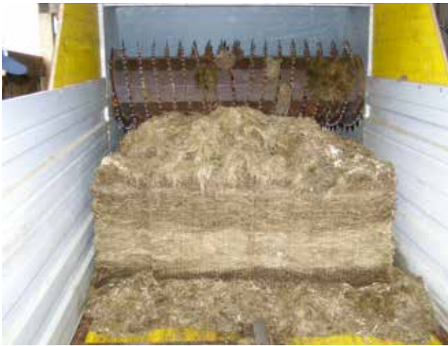
Ganze Siloblöcke, Rundballen oder loses Futter werden in die Vorratsbehälter eingespeist.
